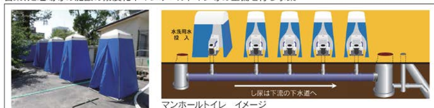
マンホールトイレ設置状況(熊本地震の際に活用)
