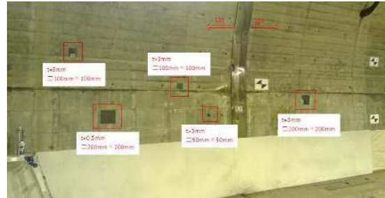
図5-2. 模擬うき設置状況
