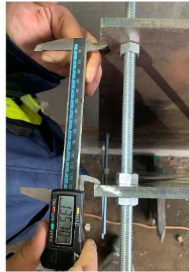
ノギスによる変化量の計測
