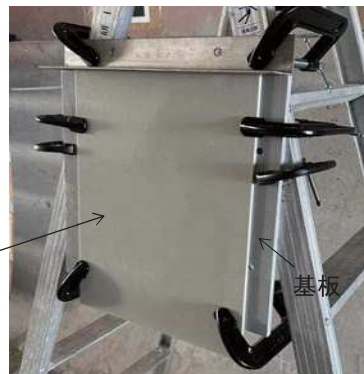
変位を模擬する平板(基板上にクランプで取付け)
