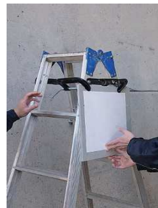
距離計評価用ターゲット (1mmプレート追加)
