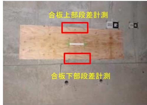
写真1 合板設置状況(合板厚12mm程度)
