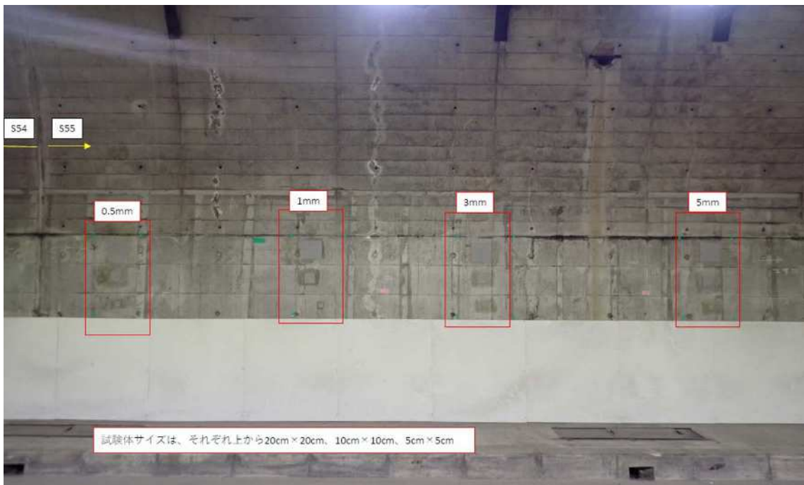
図1. 模擬うき 設置状況
