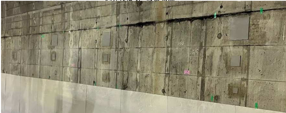
図2. 模擬うき 設置状況(拡大)
