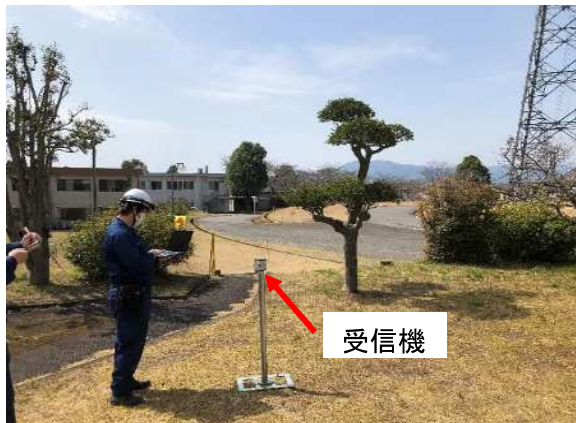
写真5c 通信試験状況 (340m地点)
