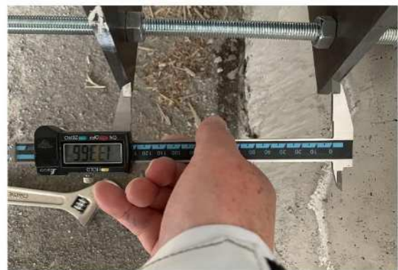
ポイント4 ノギスで内寸法を測り固定し、上下反転して表示した
