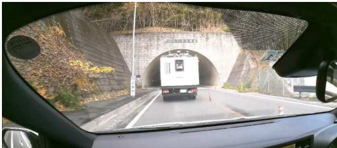
計測状況(坑口手前)(追尾車から撮影)時速60km/hr
