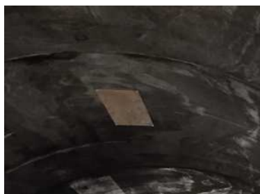
内空変位模擬の 合板(天端部の例)
