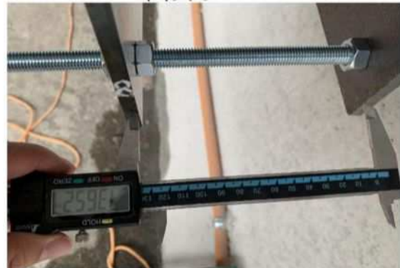
ポイント8 ノギスで内寸法を測り固定し、上下反転して表示した
