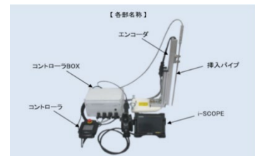
孔内撮影の使用機器
