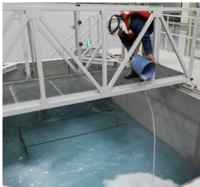
写真-12 濁度材(カオリン)投入状況
