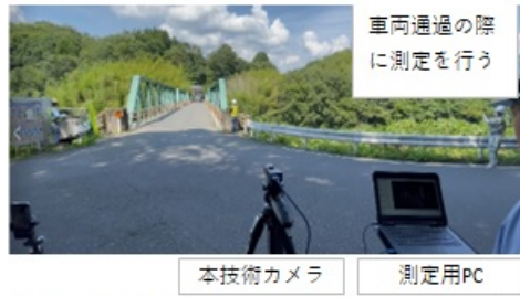
図2 本技術を用いた固有振動測定の実イメージ
