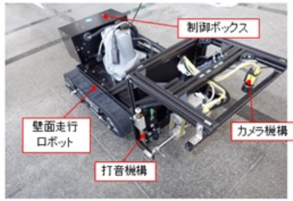
装置概要 長さ1000mm×幅530mm×高さ630mm
