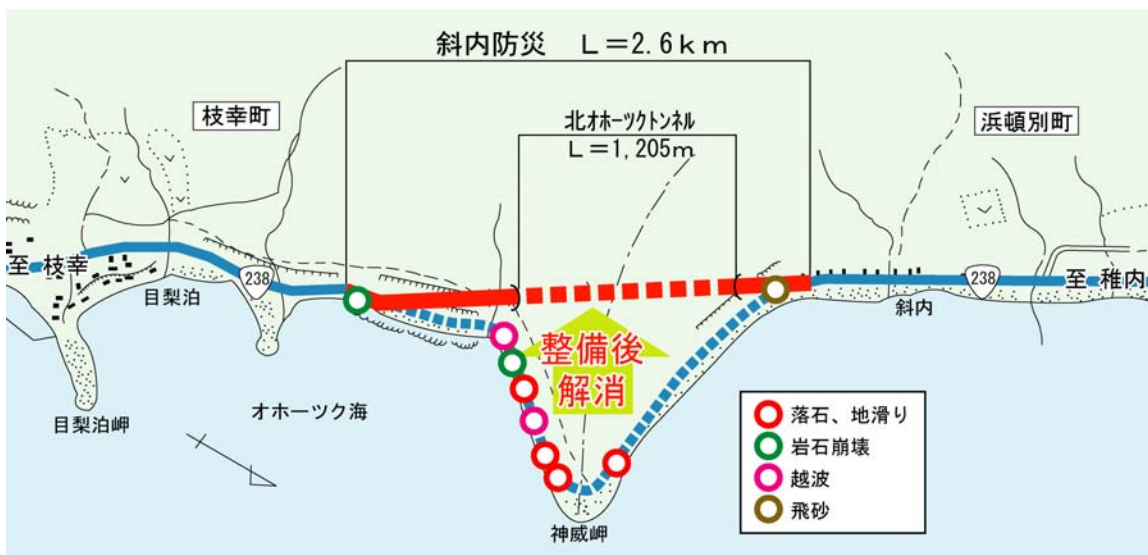
●道路防災点検における要対策箇所の状況
