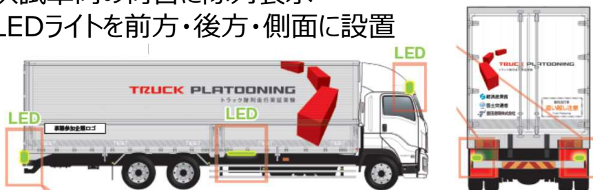
CACCシステム（協調型車間距離維持支援システム） 通信で先行車の制御情報を受信し、加減速を自動で行い、車間距離を一定に保つ機能
