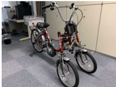
<高齢者が安心して乗ることができる 転倒しない三輪アシスト自転車研究> 【出典:東北大学平田研究室】
