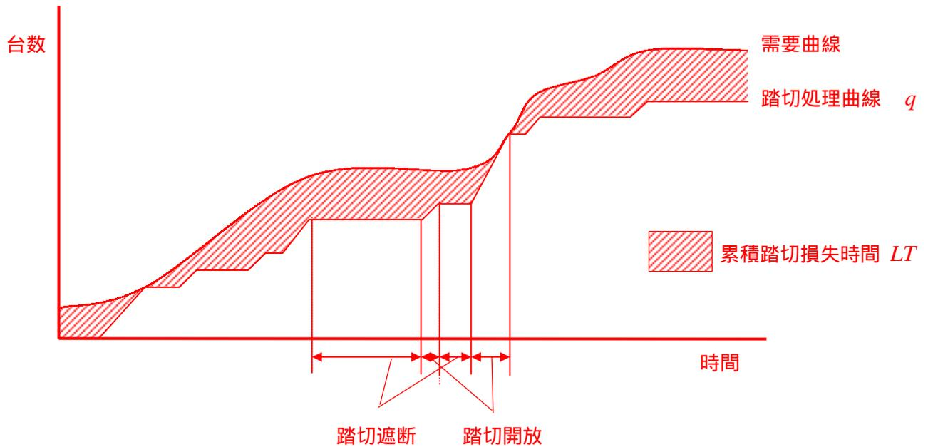
図 - 3 踏切損失時間計測の概念
