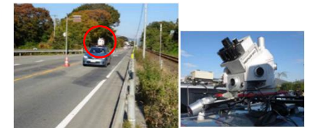
車載装置による路面性状測定
