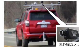
赤外線カメラによる コンクリート床版の点検
