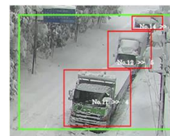
交通障害自動検知システム
