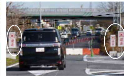
逆走警告用看板を車載カメラが読み取り、 ドライバーに警告を发出
