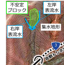
斜面山頂部からの大規模崩落 国道3号 令和2年7月豪雨
