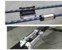
センサーを利用した 橋梁ケーブル張力の モニタリング
