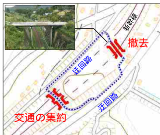
跨線橋を撤去し、隣接橋へ機能を集約
