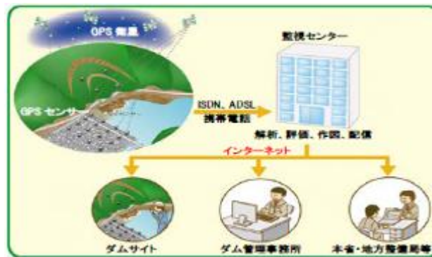
図22-3-9 GNSS ダム変形計測システム概念図
