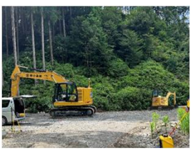
条件によるICT建機の 使い分け 左:0.8m 3 右:0.15m 3
