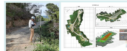
GNSS・UAV測量による3次元化
