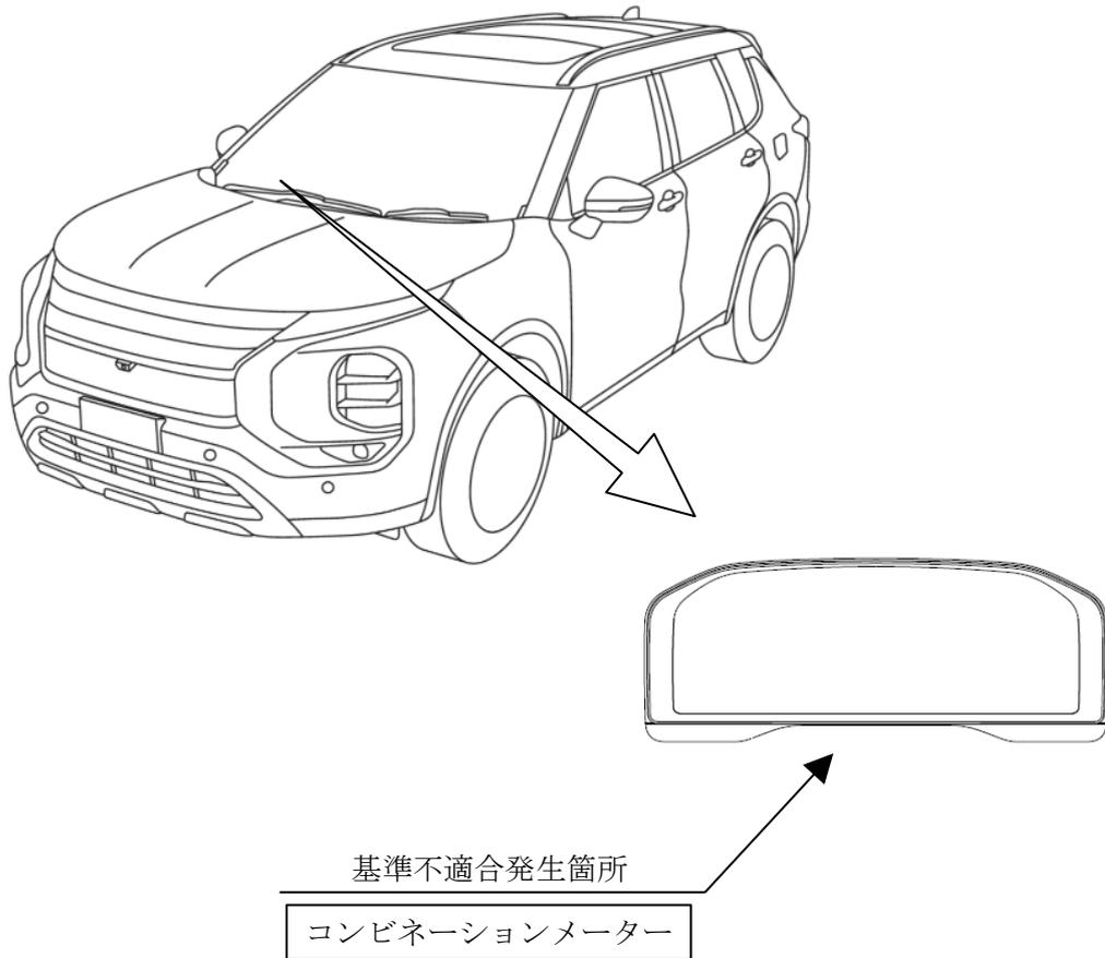
コンビネーションメーターにおいて、制御プログラムが不適切なため、車両起動時または、エンジン始動時に後席用シートベルトが非着用であることを知らせる警告表示時間が、法規で定められた表示時間を満たさないことがある。そのため、保安基準第22条の3(座席ベルト等)に適合しない。
