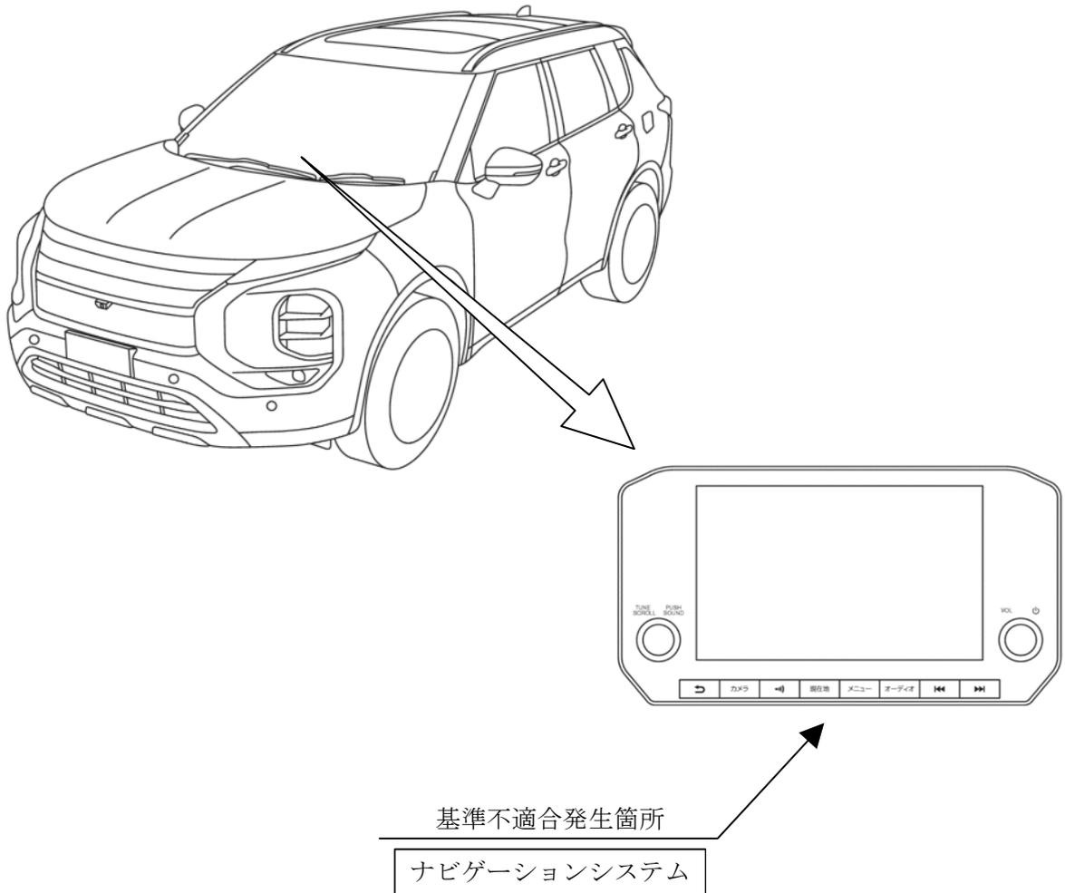
ナビゲーションシステムにおいて、制御プログラムが不適切なため、特定の操作をした場合に、液晶画面が黒くなったりフリーズしたりすることがある。そのため、液晶画面に直前直左確認用のカメラ映像が表示されず、保安基準第44条(後写鏡等の基準)に適合しなくなるおそれがある。また、後退時にリヤカメラ映像が表示されず、一部の車両においては保安基準第44条の2(後退時車両直後確認装置)に適合しなくなるおそれがある。
