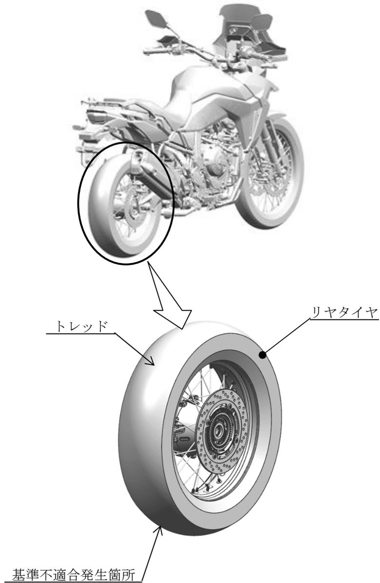
リヤタイヤにおいて、トレッド部に亀裂や変形が発生するものがある。そのため、そのまま使用を続けると、異常振動が発生し、最悪の場合、トレッド部が剥離し走行安定性を損なうおそれがある。
