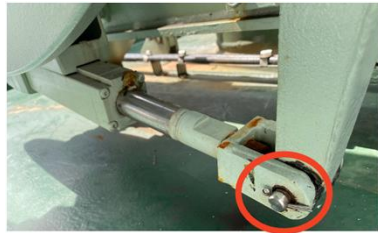
ロードセル組込候補箇所
