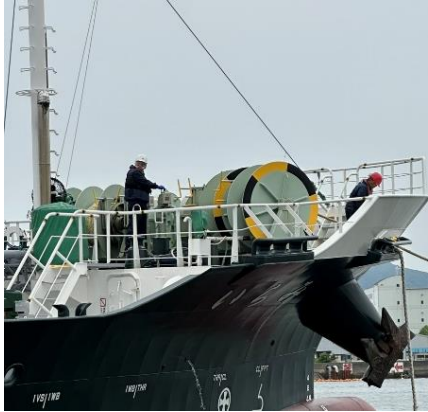
係船作業や投錨作業時のウインチ操作の様子
