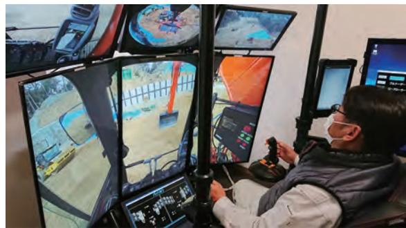
5G を活用して 3 種類の建設機械を遠隔操縦する
