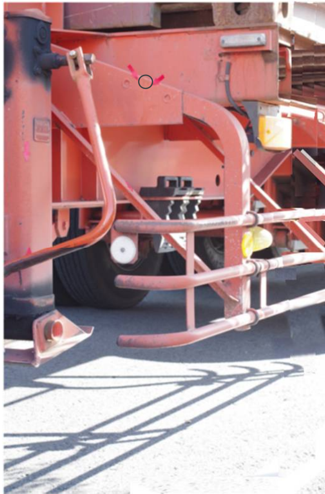
写真2 当該車両のトレーラ巻込防止装置付近の状況 (写真中の「○」は、被害者と接触したと思われる痕跡)
