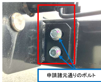
申請諸元通りのボルト取付け 【改善後】
