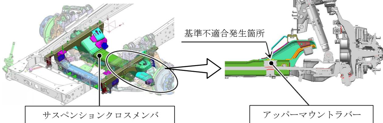
小型トラックの前輪緩衝装置において、サスペンションクロスメンバの耐久性が不足しているため、フロントリーフスプリングのアップアマウントラバーの取付部に亀裂が生じることがある。そのため、そのまま使用を続けると、当該部が破損して車両が傾き、最悪の場合、走行安定性が損なわれるおそれがある。
