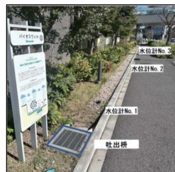
バイオスウェルの水位計設置状況
