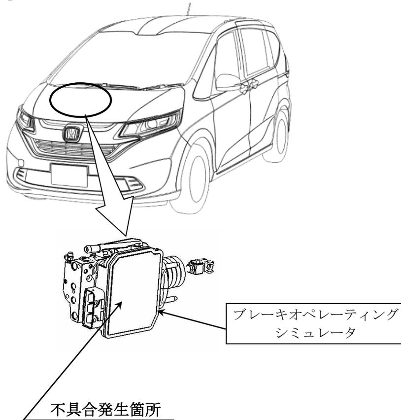
交換修理用部品の電動サーボブレーキシステムのブレーキオペレーティングシミュレータにおいて、製造工程が不適切なため、製造時に使用する組付け油が圧力センサ内に浸入することがある。そのため、使用過程で当該センサ内の抵抗部が腐食し、出力値が異常となり、警告灯が点灯するとともにフェールセーフが働き、ブレーキペダルの操作力が増大するおそれがある。
