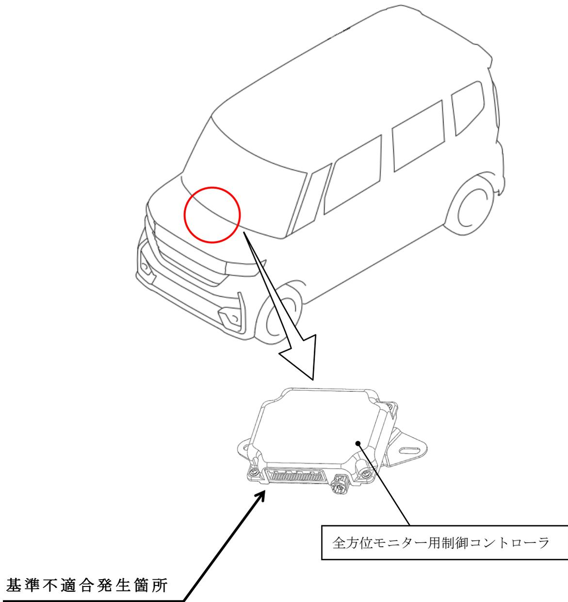
全方位モニター用制御コントローラにおいて、ソフトウェアを変更した際にソフトウェアのバージョン情報が更新されていない。そのため、協定規則第156号で定めるソフトウェア更新管理の要件に適合しない。
