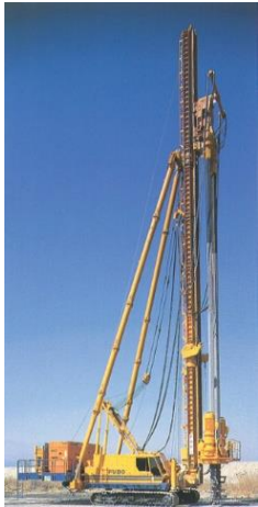
CI-CMC-HA工法施工機
