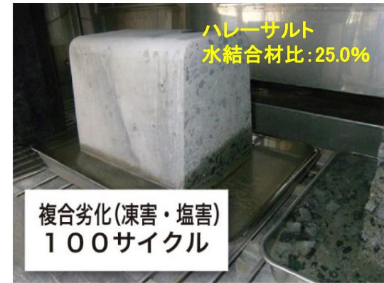
複合劣化に対する抵抗性確認試験(ハレーサルト)
