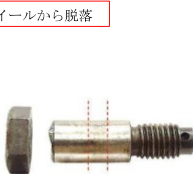
写真4 破断したリーマボルト
