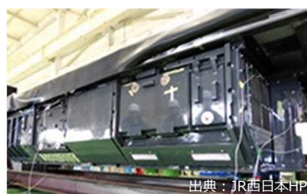
<床下の大容量発電装置>
