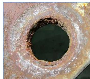
（ディスク・ホールのボルト穴や、ホイール・ナットの当たり面に、著しいさびによる剥離や損傷が発生している。）
