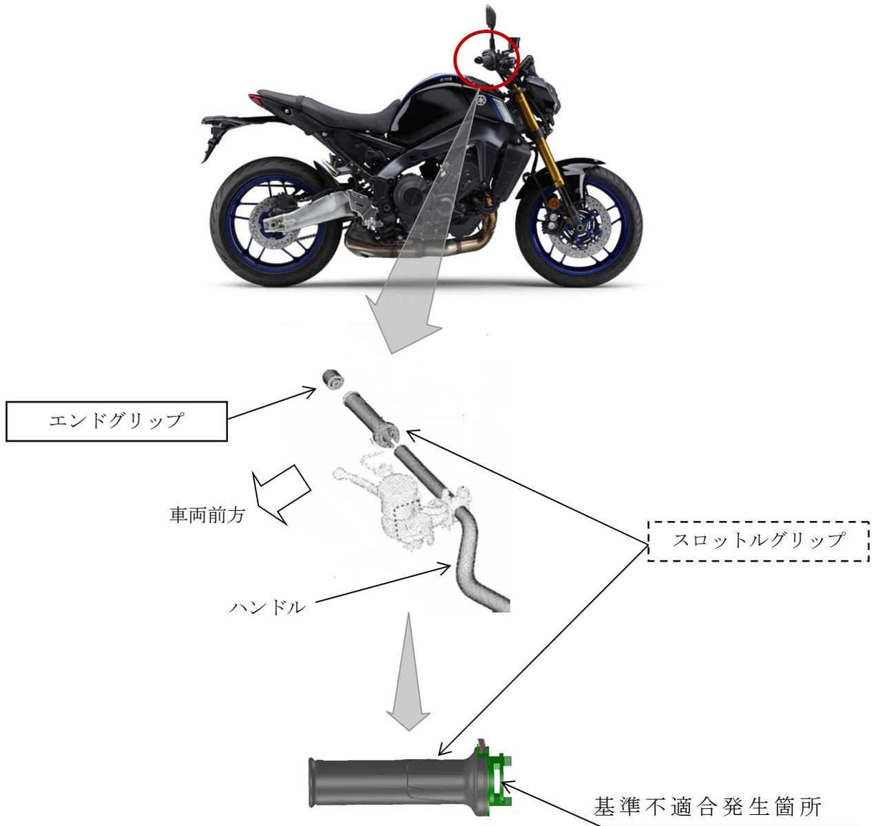
後付用品として販売したグリップウォーマーにおいて、スロットルグリップの強度が不十分のため、車両を起こす際などに当該グリップを少し回転させた状態で外側方向へ引っ張ると、過大な力が加わり、亀裂が生じることがある。そのため、当該グリップを操作する時に引っ掛かり、最悪の場合、エンジン回転数の上昇・下降ができなくなるおそれがある。
