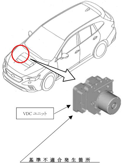
VDC (ビークルダイナミクスコントロール) ユニットにおいて、電動パーキングブレーキ 制御プログラムが不適切なため、電動パーキングブレーキが作動中に車両振動が入ると、セン サが過敏に反応し、走行中と誤認識することがある。そのため、警告灯が点灯し、電動パーキ ングブレーキが解除できなくなるおそれがある。
