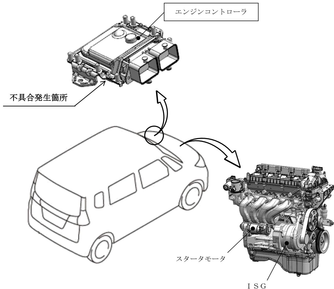
エンジンコントローラにおいて、制御プログラムが不適切なため、アイドリングストップ後のISG（モーター機能付発電機）による再始動ができなかった場合、スタータモータでのエンジン再始動に切替える保護機能が働かず、自動でエンジンを再始動できないおそれがある。
