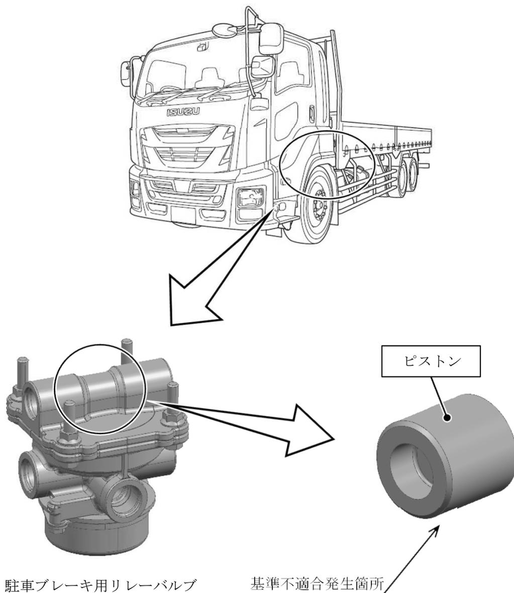
大・中型トラックの制動装置において、駐車ブレーキ用リレーバルブ内部の樹脂ピストンの材質が不適切なため、エア回路中の水分により加水分解して、ブレーキエア圧により当該ピストンが破損することがある。そのため、ブレーキバルブからのエア漏れや、駐車ブレーキの解除不能、ブレーキ引きずりが発生するおそれがある。
