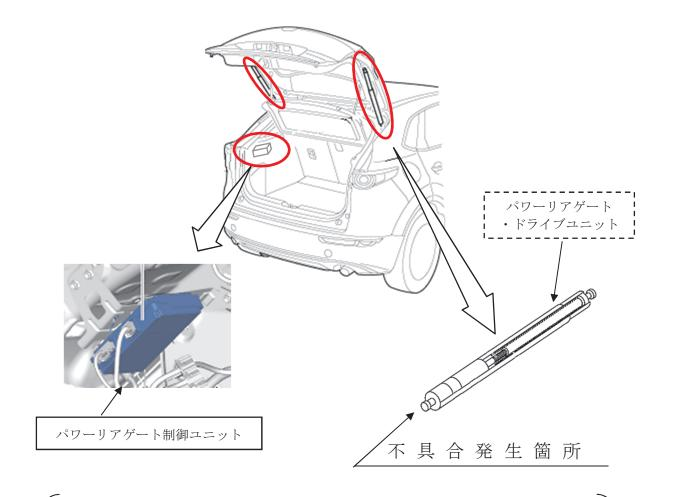
パワーリアゲートにおいて、パワーリアゲート・ドライブユニットの保持力設定が不適切なため、高温環境下での保持力が不足しているものがある。そのため、坂道に駐車する等してリアゲートを全開した場合、全開状態を保持できずにリアゲートが下がるおそれがある。
