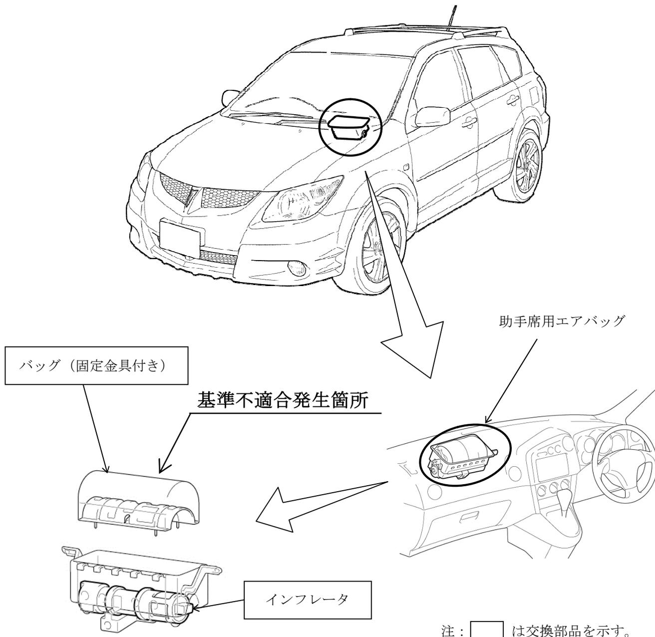
助手席用エアバッグにおいて、展開特性の検討が不適切なため、高温下でのエアバッグ作動時にバッグ内圧が想定外に高くなるものがある。そのため、バッグが破れたり、バッグ固定用金具が損傷して、正常に展開しないおそれがある。
