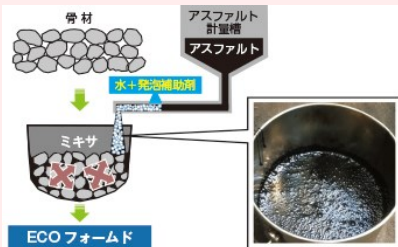
アスファルトの中温化技術
