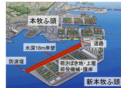
横浜港国際海上コンテナターミナル再編イメージ (2031年度完成予定)
