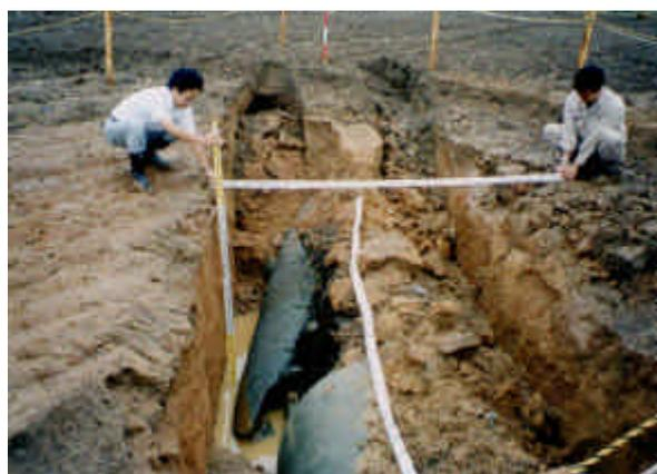
PC管破裂状況
