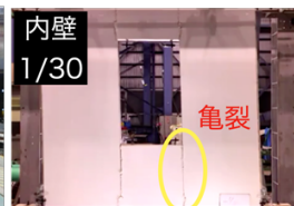
木造軸組耐力壁の加力実験
