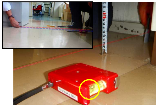
5F事務室(事務室窓側共通) : 外周部スラブが傾斜している
