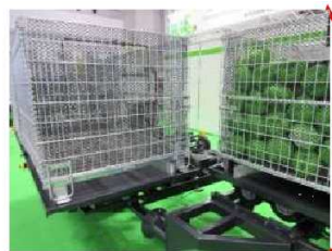
無人の運搬台車がキャベツの入ったコンテナを自動で交換し、ほ場外へ搬出
