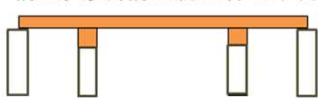
鋼製の連続桁(ヒンジなし)に 構造変更(構造物全体を架替)
