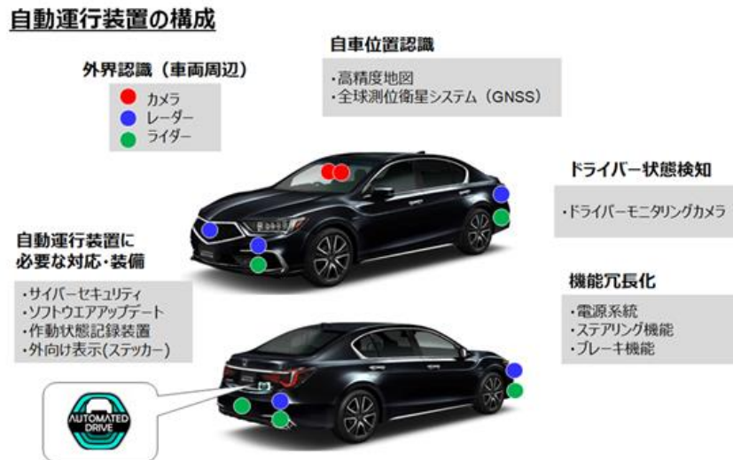
図 1-2-7. 本田技研工業（株）「レジェンド」の自動運行装置の構成
