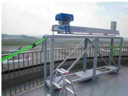
地上設置型合成開口レーダおよびアレイ型イメージングレーダを用いたモニタリング
