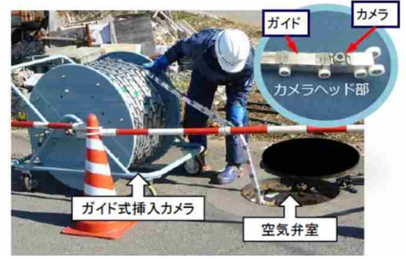
ガイド挿入式カメラを使った調査風景
