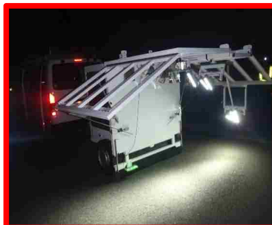
空港管理車両を活用した簡易舗装路面点検システムの研究開発
