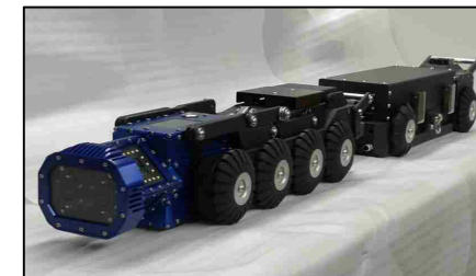
下水道管路の欠陥を画像認識技術により自動検出するロボット
