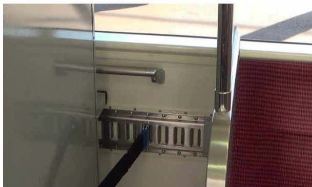
ラッシングレールの取付け
