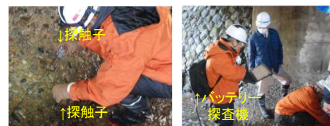
(例) 超音波探査で空洞を測定
