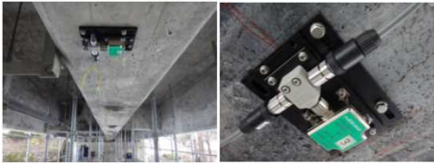
(例) 加速度からたわみを計測
