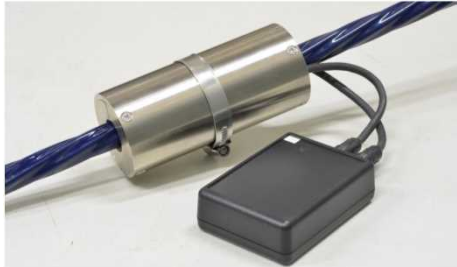
(例) 永久磁石を用いて張力を計測
