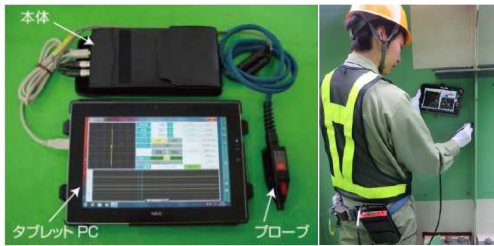
(例) 渦電流探傷法でき裂を判定
