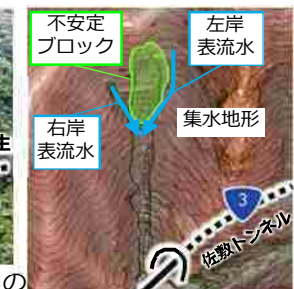
高度化された点検手法の例 レーザープロファイラ調査
