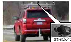
赤外線カメラによる コンクリート床版の点検
