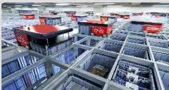
自動倉庫型ピッキングシステム
