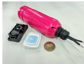
実証実験に用いている3種類の浸水センサ
